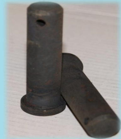
AXES MATERIAL: DIN – 16MnCr5 DIN – C60 DIN – 42CrMo4 HARDNESS 35 – 55 HRC PLASTIC, ETC.
